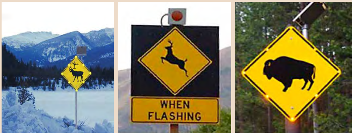
Papan tanda amaran dengan sistem lampu pengesan flashing amberlight (tenaga solar).
